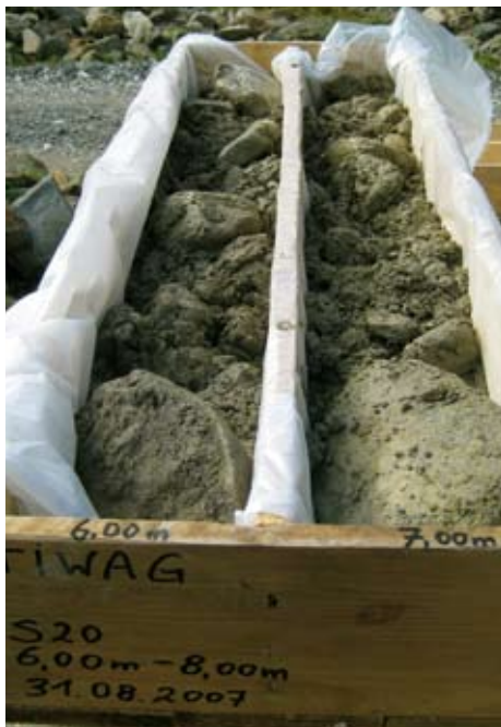
Bohrungen geben Aufschluss über die Beschaffenheit des Gesteins.
