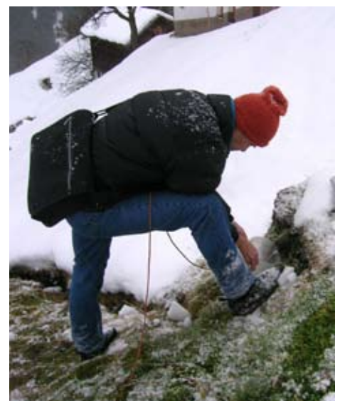
Erstbefundung einer Quelle – Messung von Temperatur und elektrischer Leitfähigkeit des Quellwassers.
