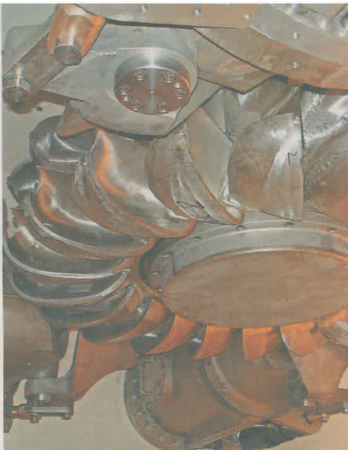
Über solche mächtigen Laufräder würde das Wasser aus dem Platztal-Pumpspeicher abgeleitet. Foto: TIWAG
